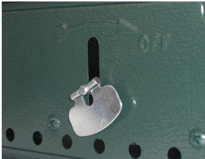
Figure 7 Commande du brûleur auxiliaire
