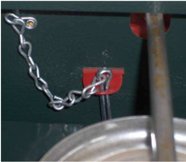
Figure 5 Fixer la chaîne de sécurité
