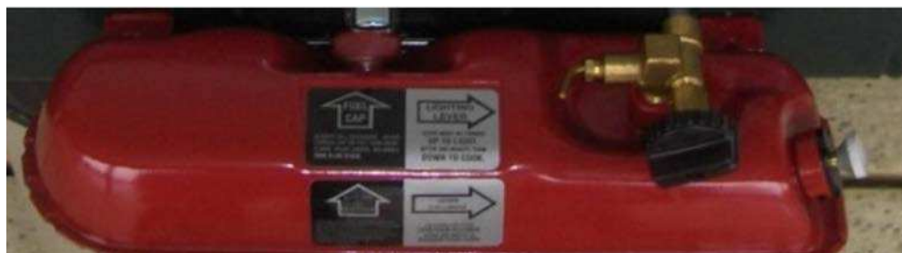
Figure 2 Réservoir de combustible
